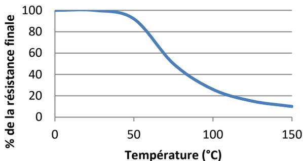
Essais de résistance au cisaillement à des températures élevées sur acier doux. Polymérisation complète à température ambiante, puis mise en température durant 30 minutes avant réalisation des essais.
