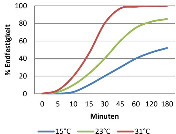
Das Diagramm zeigt den typischen Aufbau der Festigkeit bei der Verklebung von Probestücken. Wird die Temperatur um 8°C erhöht, halbiert sich die Aushärtezeit. Niedrigere Temperaturen haben eine langsamere Aushärtung zur Folge.
