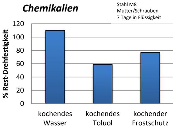
Dieses Produkt ist nicht geeignet für Verbindungen, die in direktem Kontakt mit Dampf oder reinem Sauerstoff stehen. Ein längerer Kontakt mit starken Säuren, Laugen oder stark polaren Lösungsmitteln ist zu vermeiden. Warnung: Das Produkt könnte u.U. einige Thermoplaste angreifen. Dem Anwender wird daher empfohlen, vor Gebrauch eine entsprechende Verträglichkeitsprüfung durchzuführen.
