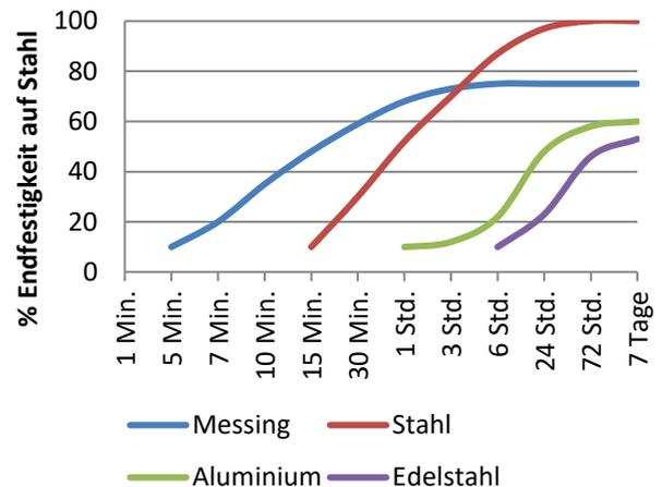
\* Dies sind typische Werte auf Stahlflächen bei 23°C. Kupfer und Kupferlegierungen beschleunigen die Aushärtung, inaktive Oberflächen (wie rostfreier Stahl oder Zink) sowie niedrige Temperaturen und große Spalte verlängern die Aushärtezeit. Um die Aushärtezeit zu verringern, kann der Oberflächenaktivator Permabond A905 verwendet oder die Verklebung erwärmt werden.
