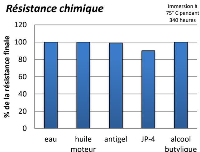
Ce produit n’est pas recommandé pour une utilisation en contact avec des matériaux s’oxydant facilement. Attention ! Ce produit risque d’endommager certains thermoplastiques. Il est donc conseillé de vérifier leur compatibilité avant utilisation.
