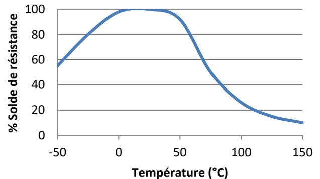
Essais de cisaillement en température réalisés sur l'acier doux. Polymérisation de 24h à température ambiante, puis mise en température durant 30 minutes avant réalisation des essais.
