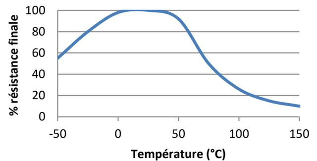
Tests de résistance au cisaillement à des températures élevées sur acier doux. Polymérisation complète à température ambiante, puis mise en température durant 30 minutes avant réalisation des essais.
