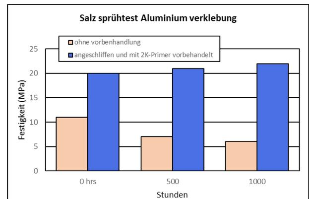
Das Diagramm zeigt die Festigkeit der Verklebung mit strukturellem Acrylat ohne/mit Verwendung von Permabond 2K-Primer auf Aluminium. Die Beständigkeit der Verklebung wird wesentlich erhöht.
