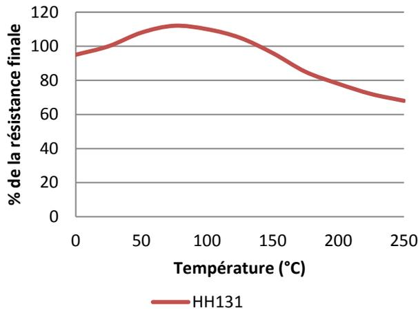
*"Dureté à chaud" Couple de rupture sur des boulons M10 en acier zingué selon la norme ISO 10964. Polymérisé à 23° pendant 24 heures puis conditionné pendant 30 minutes à des températures d'essai.*
